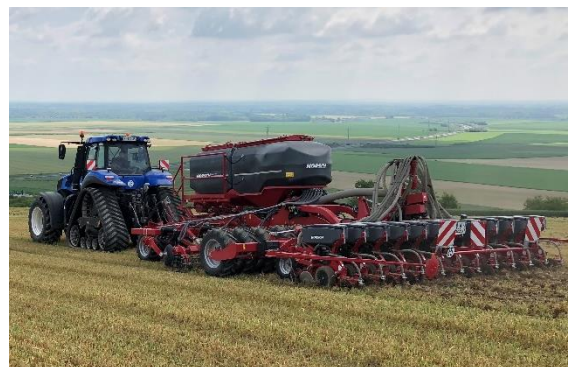
Semoir Maestro attelé au Focus TD, permettant l'implantation d'un maïs en un seul passage
